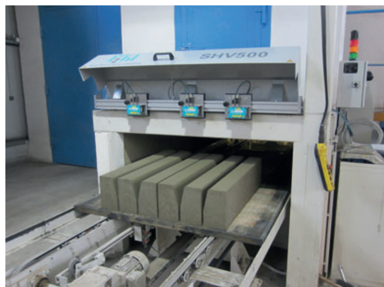
Die unter dem Gerät durchlaufenden Betonwaren werden berührungslos mit den Lasersensoren abgetastet und mit einer Genauigkeit von +/- 0,5 mm vermessen.
